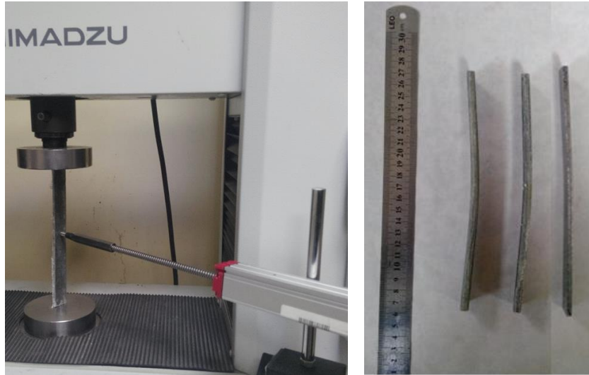
Şekil 5. GFRP takviyeli numunelerde burkulma deneyi
